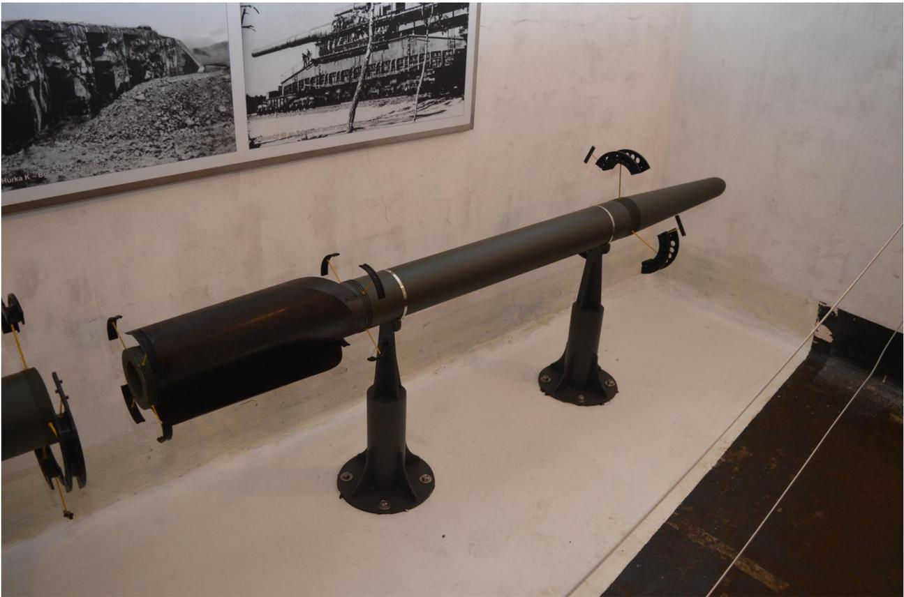
Ces deux sabots se séparaient au moment où l'obus quittait le canon, permettant ainsi aux ailettes de se déployer pour stabiliser la trajectoire de l'obus. Au départ, celui-ci tournait rapidement sur lui-même sous l'effet des rayures du tube, mais ce mouvement giratoire était progressivement contrôlé et ralenti par les ailettes, stabilisant ainsi le projectile sur sa trajectoire. D'où une très grande précision de tir qui en faisait une arme redoutable.
