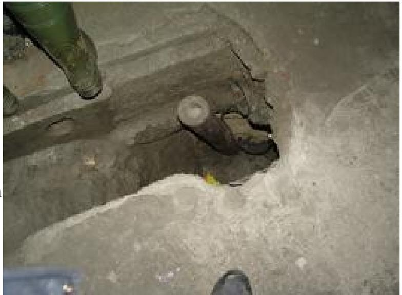
Les projectiles utilisés à Aubin-Neufchâteau étaient dépourvus d'explosifs puisqu'il s'agissait simplement de tester leur capacité de pénétration contre le béton et les masses couvrantes des fortifications modernes. Les résultats furent néanmoins époustouflants et dépassèrent toutes les attentes des spécialistes en balistique: les dards traversèrent une épaisseur de 30 mètres de terre et perforèrent la voûte des galeries
